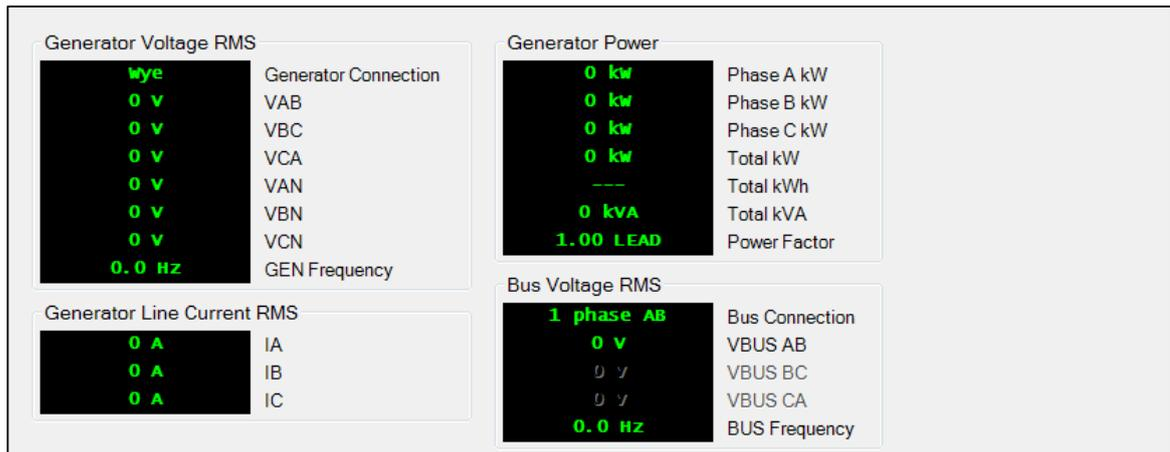
Figure 28. Metering Explorer, Generator Screen
