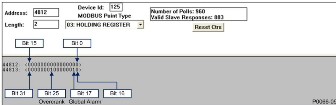
Figure 100. 32-Bit Bit-Mapped Parameter Mapping
